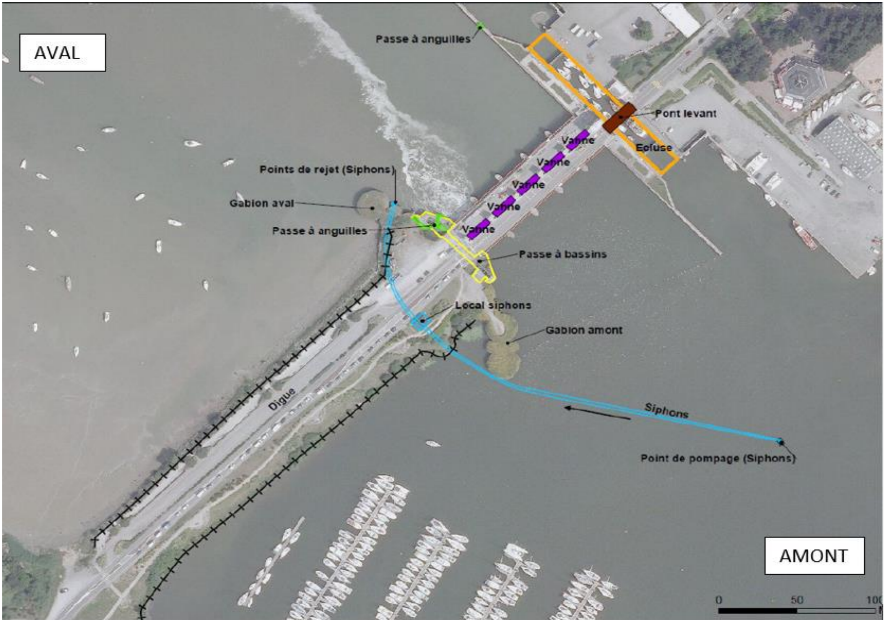
Figure 5 : Vue en plan du barrage et de ses principaux équipements
