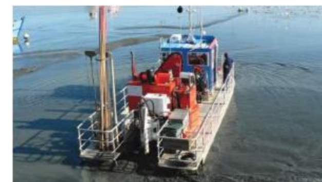
Figure 27 : Rotodévaseur, propriété de l'IAV
